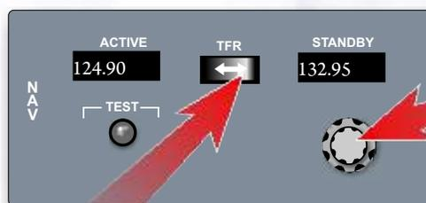
En algunos modelos 737 **PRIMERO** introduce la frecuencia en el lado **STANDBY** del panel de la radio.
