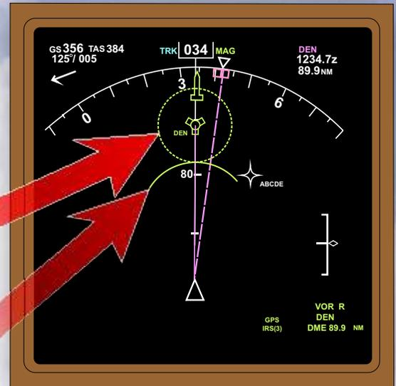
A aproximadamente 90 millas de Denver pasa a V/S y ves ajustándolo para efectuar un descenso de tal forma que el arco verde de previsión del punto en que se llegara a la altura introducida en el MCP coincida con el borde del círculo de las 30 millas. Si este descenso se ajusta al T/D, tienes la opción de seguir con este procedimiento, o (si coincide con esta solución) deja que el VNAV se encargue del descenso.
